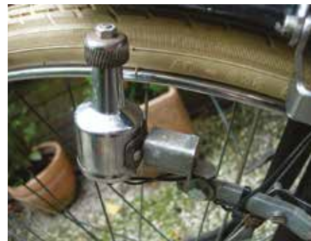
Generador de electricidad (dínamo) conectado a la rueda de una bicicleta. Se utiliza para encender una luz que ilumina el camino durante la noche.
